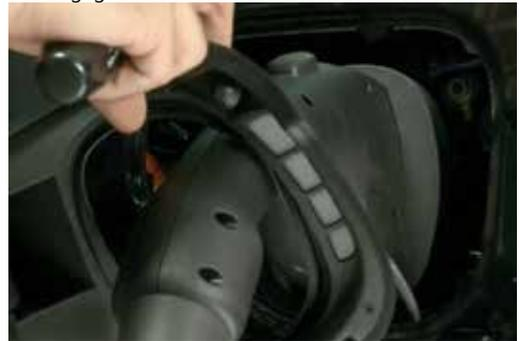
9. Avec le tournevis derrière le levier de desserrage, faites pivoter le levier vers vous et vers le bas
