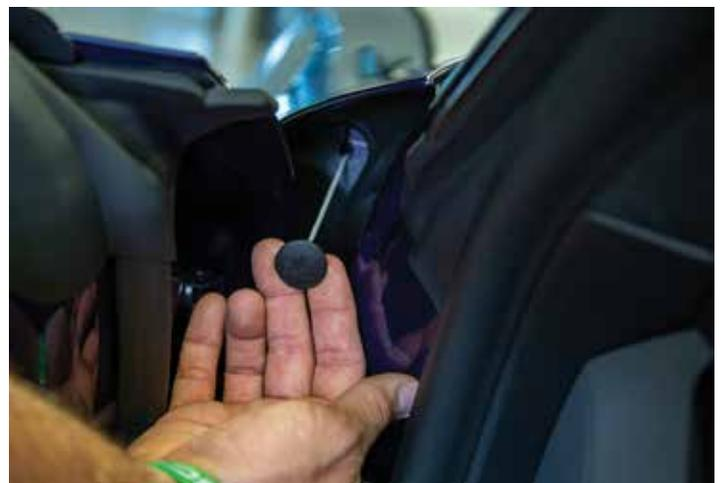
Tirez la poignée de déverrouillage vers l'arrière du véhicule.
