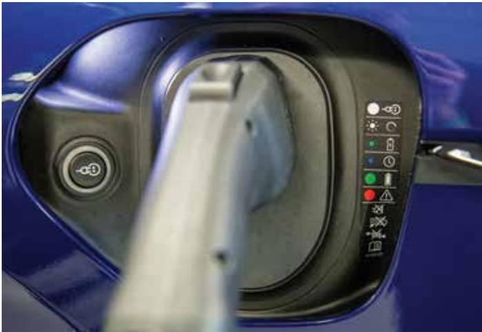
Dans le cas peu probable où la prise de chargement refuse de se désengager du port de recharge, un déverrouillage mécanique est possible pour libérer la prise de chaque côté du véhicule.
