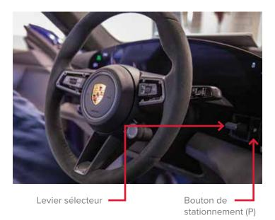
Lorsque le véhicule est en marche, il peut passer entre les positions stationnement (P), marche arrière (R), point mort (N) ou marche avant (D).
