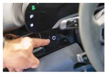
Le bouton de d'allumage-démarrage est situé à gauche de la colonne de direction. Appuyez sur le bouton pour faire démarrer le véhicule.
