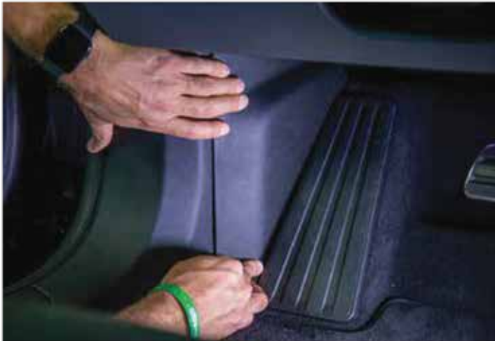
Retirez le panneau de protection dans le plancher côté conducteur.
