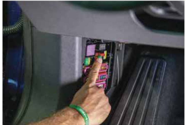
Retirez la borne positive rouge. Effectuez la connexion positive de 12 volts à partir de la source d'alimentation.
