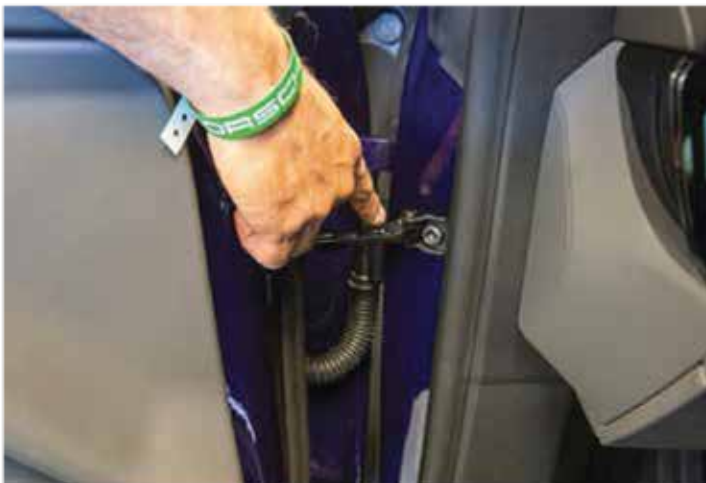
Effectuez la connexion négative de 12 volts au ferme-porte sur la porte côté conducteur.
