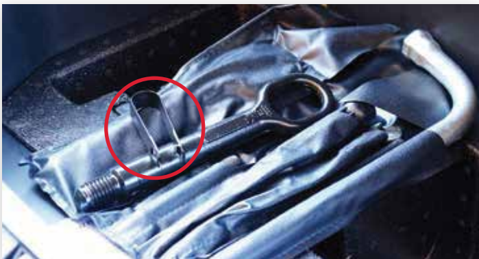
Vous aurez besoin d'un outil pour retirer les caches décoratifs des écrous de roue.
