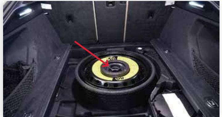
Retirer l'écrou de retenue en plastique de la roue de secours gonflable
