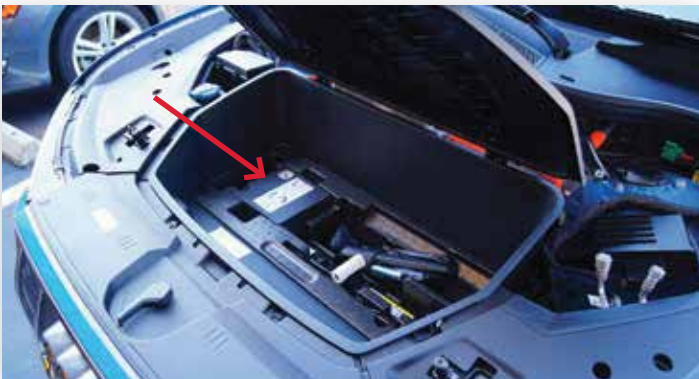
La trousse à outils et le compresseur d'air se trouvent sous le plancher du compartiment de rangement avant, sous le capot.
