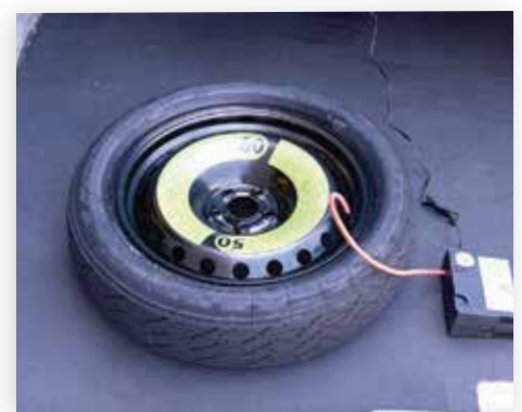
Lorsque le pneu approche de la pression recommandée, les deux flancs s'aplatissent, le flanc arrière reposant à plat sur le sol.
