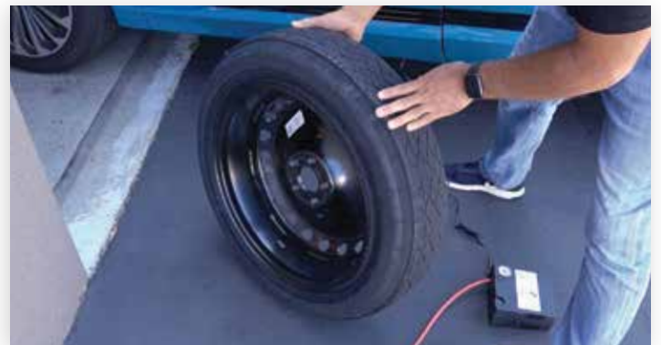
Lorsque le pneu est entièrement gonflé, le flanc avant présente un bombement plus prononcé tandis que le flanc arrière est plat.
