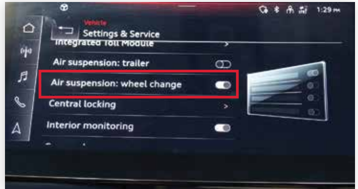
Faites défiler vers le bas et sélectionnez SUSPENSION PNEUMATIQUE : CHANGEMENT DE PNEU (Air Suspension: Wheel Change) comme indiqué
