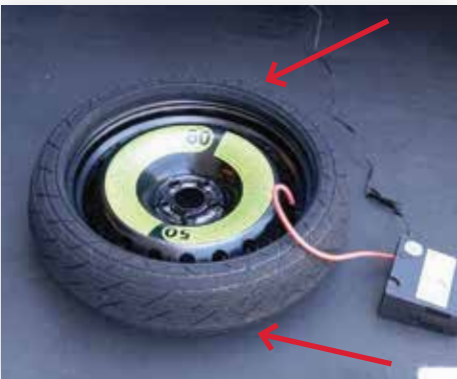
Au début du gonflage, le flanc avant se déploie en roulant vers le haut et en tirant le flanc arrière vers le haut.
