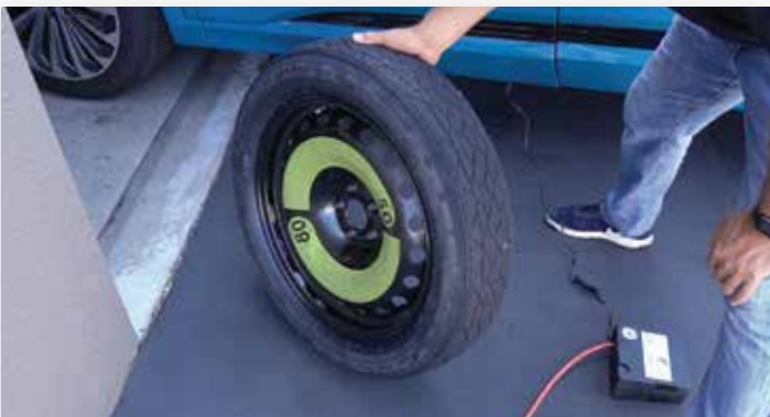
Lorsque le pneu est entièrement gonflé, le flanc avant présente un bombement plus prononcé tandis que le flanc arrière est plat.
