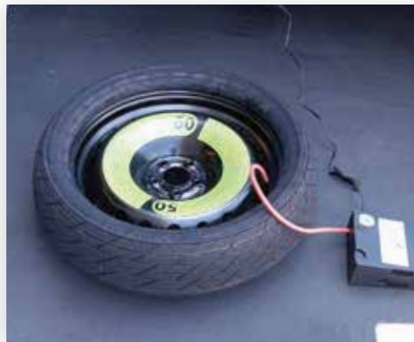
Les flancs avant et arrière continueront à s'enrouler tout au long du gonflage.
