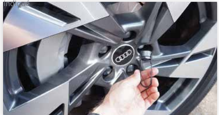
Retirer les caches des écrous de roue.
