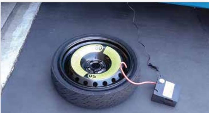
Le pneu de secours DOIT être gonflé sur le dos avant d'être installé sur le véhicule. Voir l'étiquette de pression des pneus à l'intérieur de la porte du conducteur pour la pression recommandée. Le temps de gonflage est de 6 à 8 minutes.
