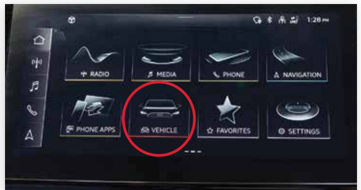
Avant de mettre le véhicule sur cric pour changer les pneus, la suspension pneumatique doit être désactivée. Depuis le menu principal, appuyez sur le menu VEHICULE ou VOITURE sur l'écran tactile
