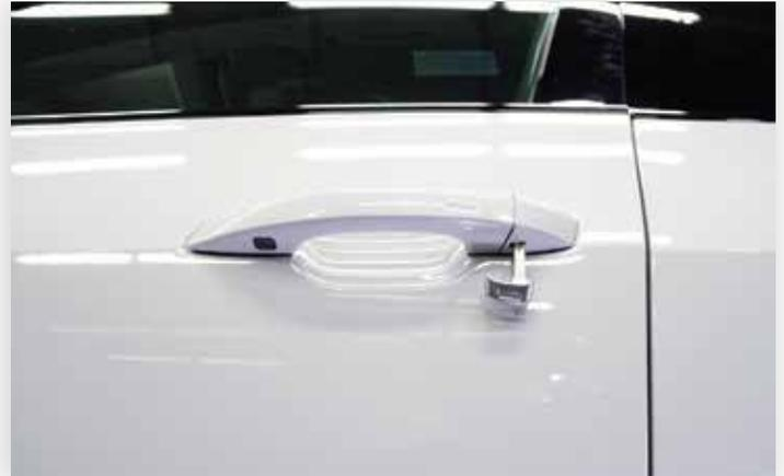
Insérez la lame de la clé dans la fente du couvercle du cylindre de la serrure. Tirez doucement sur la lame de la clé pour retirer le couvercle.
