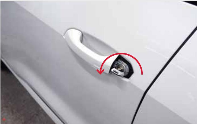
Insérez la lame de la clé dans le cylindre de la serrure
