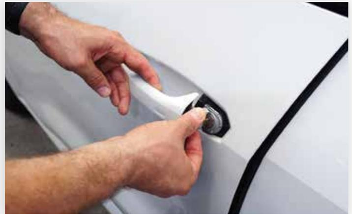
La lame de la clé étant tournée à fond dans le sens inverse des aiguilles d'une montre tirez fermement la poignée pour ouvrir la porte
