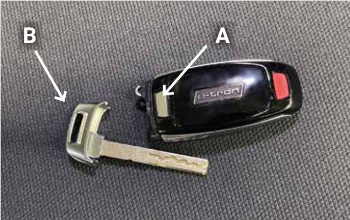
Appuyez sur le bouton situé à l'arrière de la télécommande (A) pour retirer la lame de clé mécanique (B)
