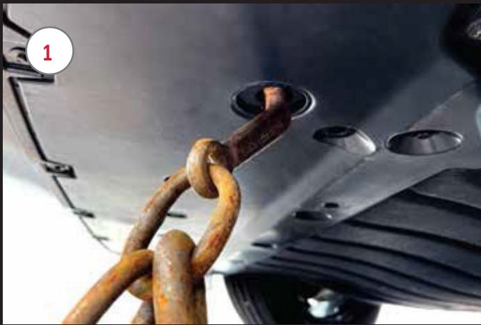
1 Établir des connexions avec la Mustang Mach-E désactivée aux ouvertures rondes sous le pare-chocs avant
