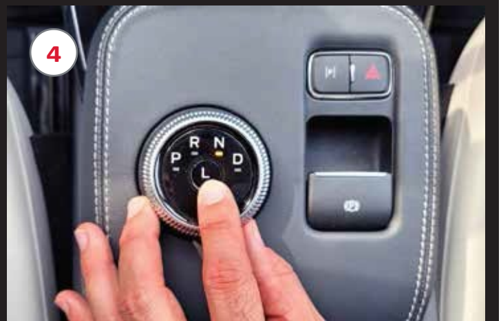
4 Appuyez sur 'L' au centre du levier de Vitesse rotatif
