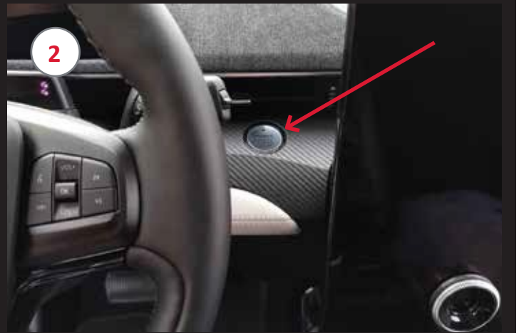
2 Avec le porte-clés présent, appuyez sur le bouton 'Démarrer/Start' pour allumer le véhicule
