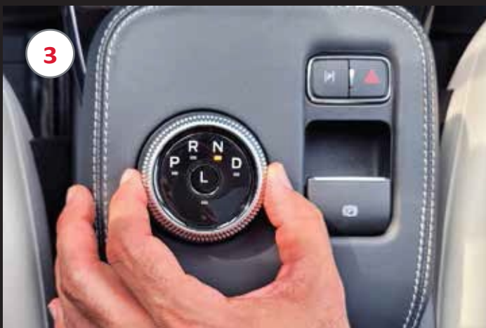
3 Mettez le véhicule en position 'N' neutre avec le levier de vitesses rotative dans la console centrale
