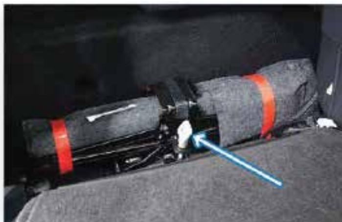
Dévissez le boulon à oreilles du support de cric pour retirer le cric et la trousse à outils.
