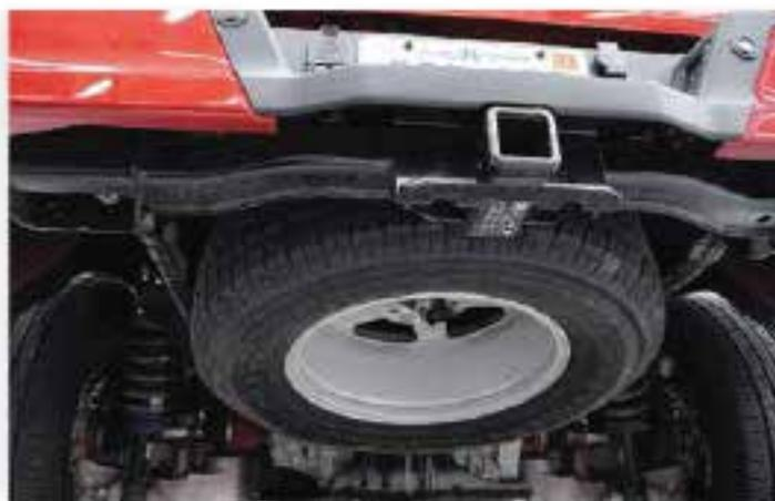
Assemblez le levier de manœuvre du cric et l'insérer dans l'orifice du pare-chocs pour faire baisser la roue de secours
