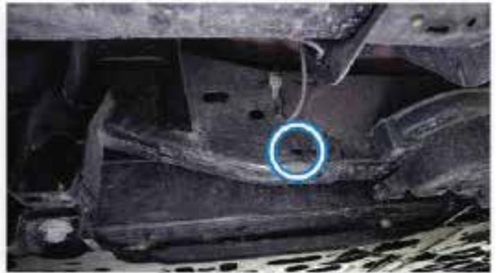
Points de levage arrière du longeron de cadre côté passager
