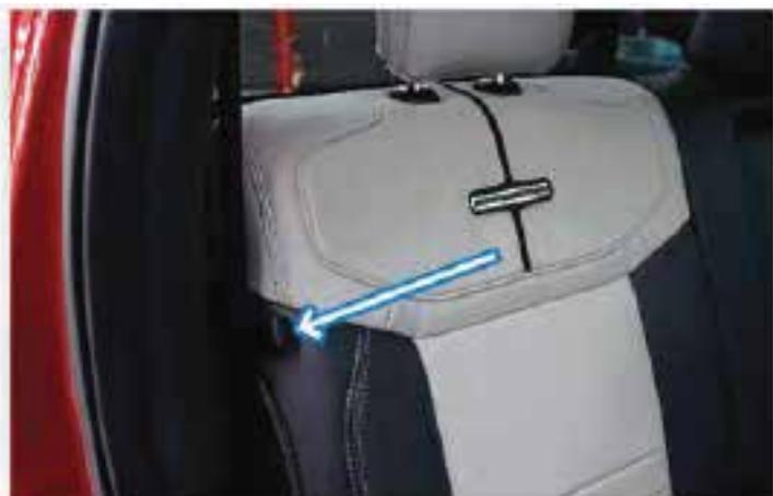
Le dossier du siège arrière côté passager se replie vers l'avant - Tirez sur la boucle
