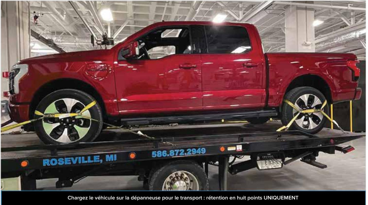
Chargez le véhicule sur la dépanneuse pour le transport : rétention en huit points **UNIQUEMENT**
