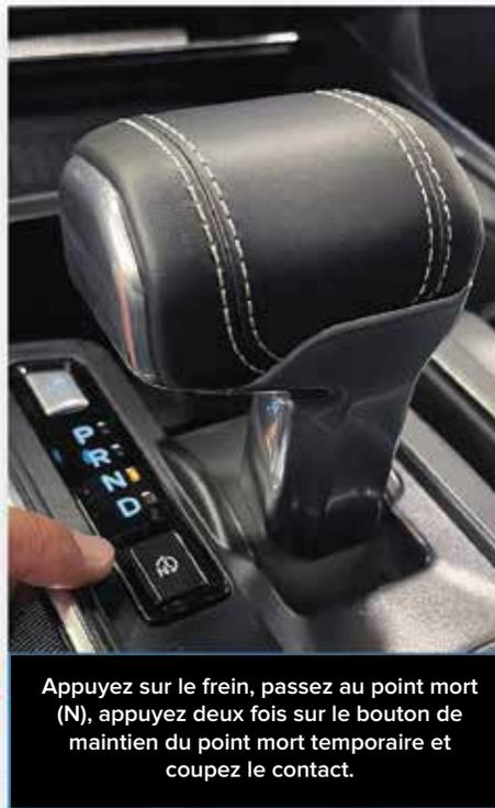
Appuyez sur le frein, passez au point mort (N), appuyez deux fois sur le bouton de maintien du point mort temporaire et coupez le contact.
