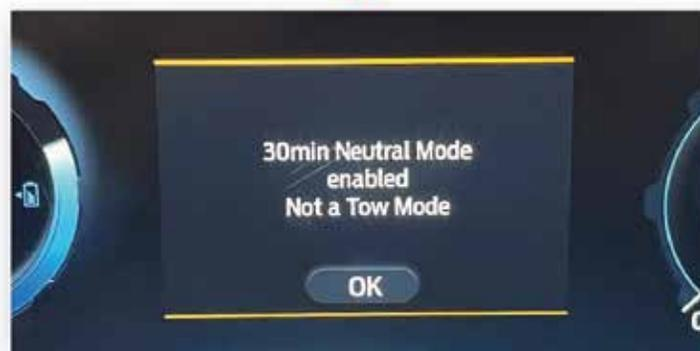
Nota : Un message de confirmation s'affiche lorsque le véhicule passe dans ce mode indiquant de ne pas remorquer le véhicule dans ce mode.
