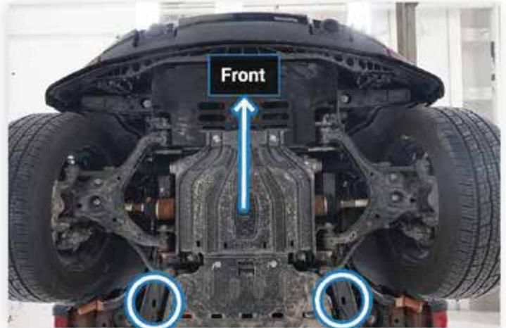
Effectuez les connexions au F-150 Lightning immobilisé au niveau des fentes au bas du châssis derrière les supports de la barre stabilisatrice.
