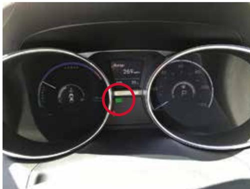
Lorsque le témoin vert « READY » s'allume sur le tableau de bord, le boîtier de démarrage peut être retiré et le véhicule est prêt à fonctionner.
