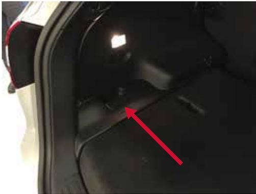
La batterie de 12 volts du véhicule est située dans l'espace de chargement dans le coin arrière gauche.
