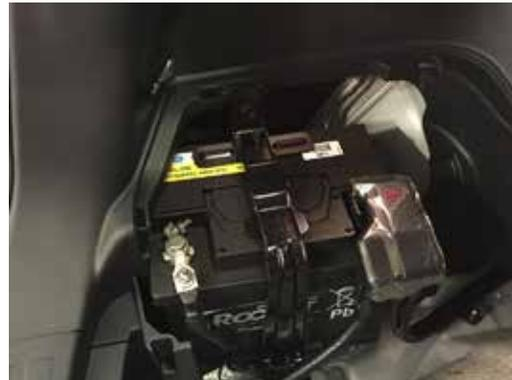
Connectez le boîtier de démarrage à la batterie.
