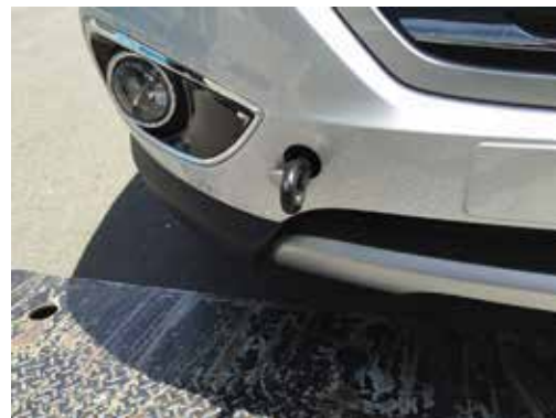
Œillet de remorquage installé - avant
