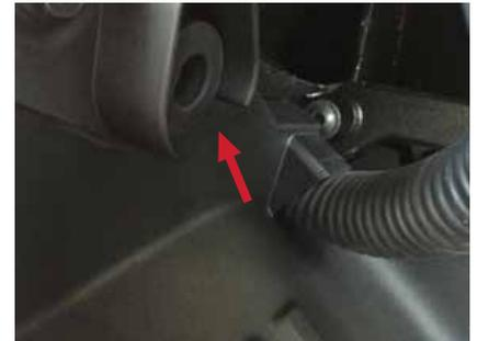
Le "capot" ou le couvre-bagages avant peut maintenant être ouvert à l'aide du dispositif de déverrouillage manuel situé dans la partie inférieure de l'habitacle du conducteur manuelle qui se trouve dans la partie inférieure de l'ouverture de la portière du conducteur pour accéder au compartiment abritant la batterie de démarrage au lithium-ion.
