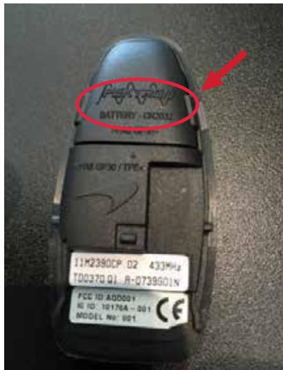
Le couvercle de la pile peut être retiré avec une pièce de monnaie ou l'ongle du doigt à partir de cette languette sur le côté.
