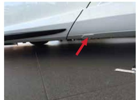
Le couvercle du bas de caisse côté conducteur doit être démonté. Pour ce faire, tirez l'onglet de verrouillage vers l'avant sur le rebord arrière du panneau. Pour libérer le couvercle, le tourner vers le bas et le tirer vers le centre du véhicule.
