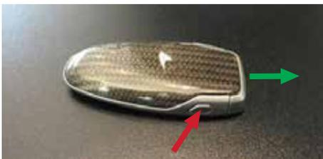
Pour ouvrir manuellement la portière de la 650S, la clé mécanique doit être retirée de la télécommande.
