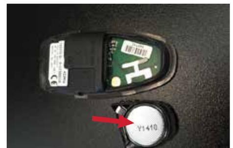
Faites attention à l'orientation de la batterie pour la réinstallation de la nouvelle batterie.
