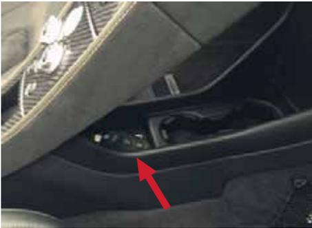
Essayez de démarrer le véhicule. Si le véhicule démarre, la pile de la télécommande doit être remplacée. Passez à la section suivante : « Remplacement de la pile de la télécommande de clé ».
