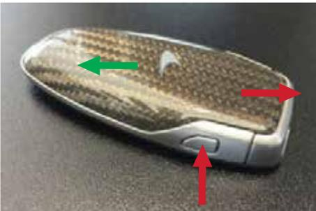
Appuyez d'abord sur le bouton situé sur le côté de la télécommande et retirez la clé mécanique de la télécommande.
