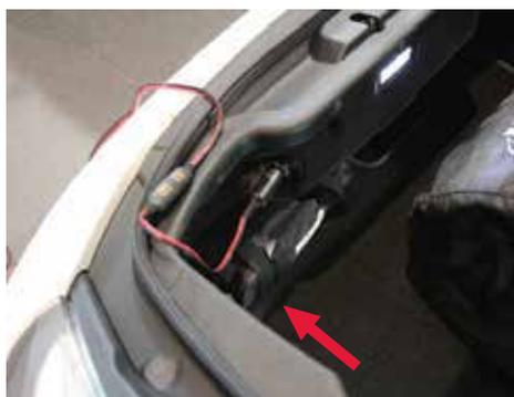
Localisez la prise correspondant à l'alimentation 12 volts qui alimente le véhicule et branchez-la dans le port de charge situé côté conducteur du compartiment à bagages.
