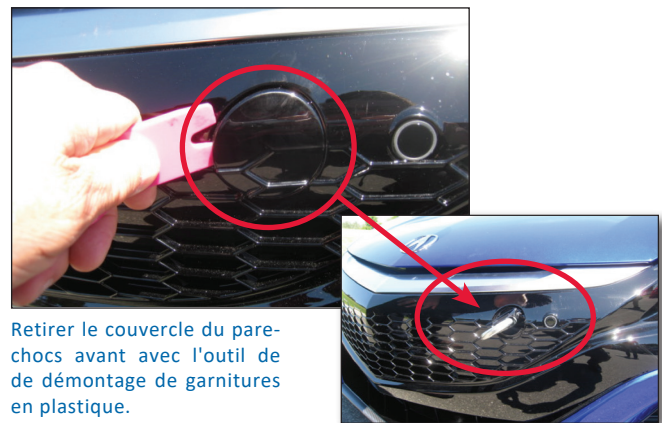
Crochet de remorquage inséré dans le pare-chocs avant
