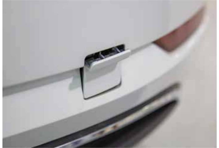
**ARRIÈRE :** Appuyez sur le bas du couvercle de l'œillet avant pour le retirer.
