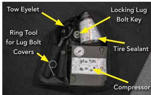
Clé de verrouillage de roue
