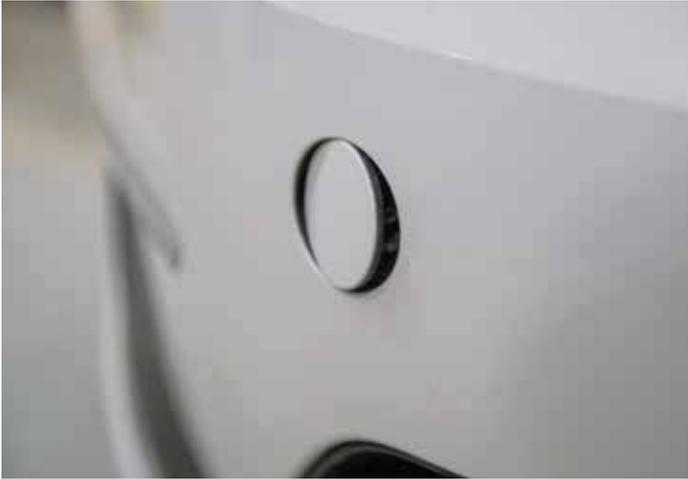
**AVANT :** Appuyez sur le côté gauche du couvercle de l'œillet avant pour le retirer.
