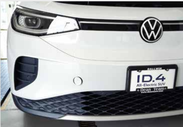
Oeillet de remorquage dans le pare-chocs avant
