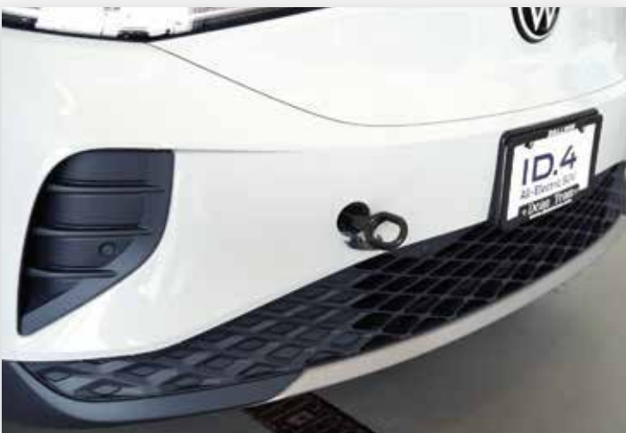
L'œillet de remorquage est fileté à gauche
