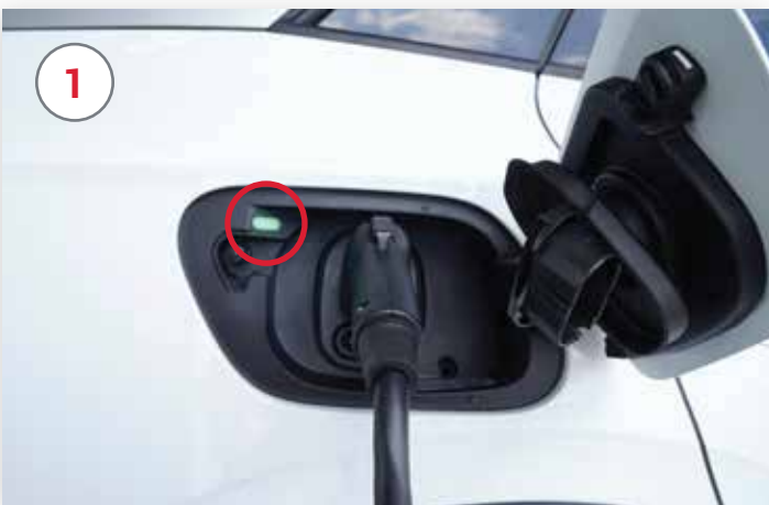
Pendant la charge, le voyant d'état de charge est vert. et la prise ne peut pas être libérée.
