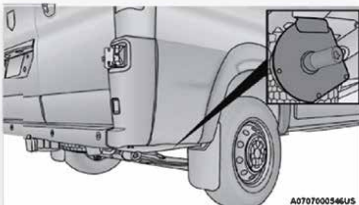
Emplacement du treuil
