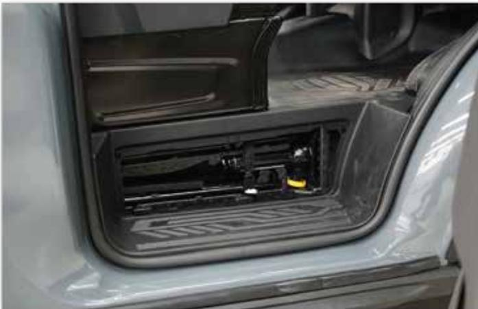
Le cric articulé et les outils de changement de pneu se trouvent dans l'espace de chargement sous le siège passager.
