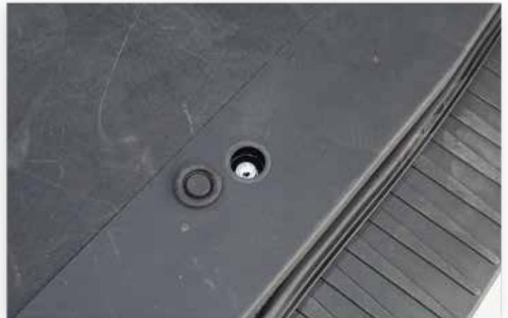
Pour descendre la roue de secours, utilisez la poignée de manœuvre du cric ou la clé à écrous raccordés à la rallonge de douille carrée pour faire tourner l'écrou de la roue de secours qui se trouve sous un bouchon de caoutchouc au centre arrière du plancher de l'espace de chargement, juste à l'intérieur de l'ouverture du hayon.
