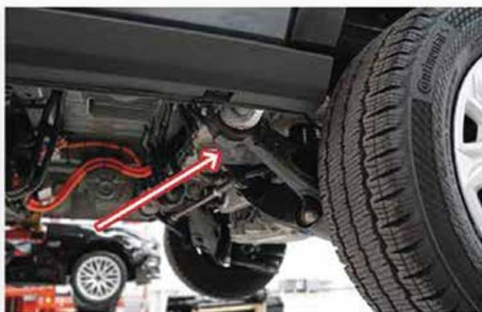
Points de levage: devant la roue arrière, plaque de renforcement de la bague de bras de suspension extérieure
