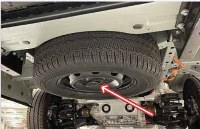
Déposez l'écrou de fixation pour détacher le support de roue de secours pour libérer la roue.
