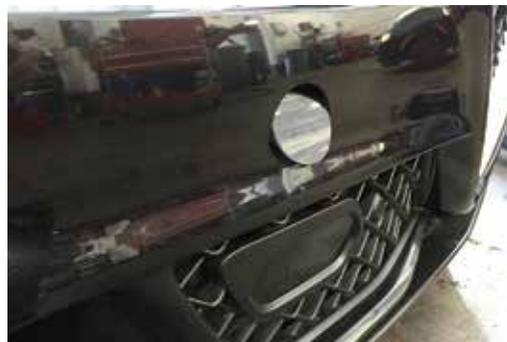
Décrochez le bouchon de l'œillet de remorquage situé sur le pare-chocs avant en appuyant sur la partie supérieure.
