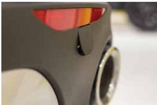
Le bouchon de l'œillet de remorquage arrière s'enlève à l'aide d'un outil de démontage de garniture en plastique, en commençant par le bas.
