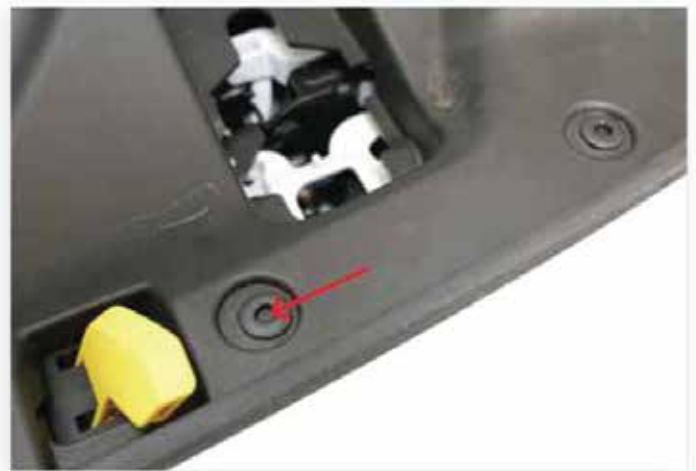
Pour démonter ces rivets pression, utiliser un tournevis, un stylo ou un outil similaire pour enfoncer la goupille de verrouillage au milieu du rivet.
