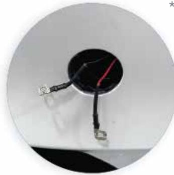
\* Pour les véhicules sans alimentation 12V, le coffre avant peut être ouvert à l'aide de deux petits câbles volants qui se trouvent derrière le cache anneau de remorquage.
