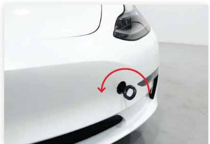
L'anneau de remorquage est filetage à gauche; l'insérer complètement dans l'ouverture, puis le tourner dans le sens antihoraire jusqu'à ce qu'il soit bien fixé.
