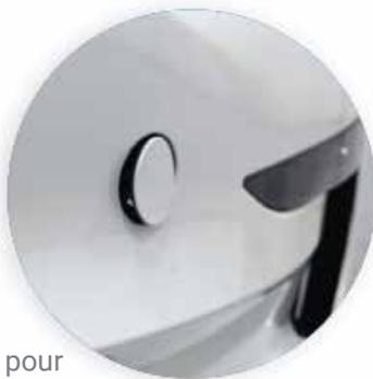
Pour retirer le cache anneau de remorquage pour dégager le cache anneau de remorquage, appuyez fermement sur la partie supérieure droite du cache jusqu'à ce qu'il pivote vers l'intérieur et tirez délicatement sur la section relevée; un outil en plastique peut faire levier.
