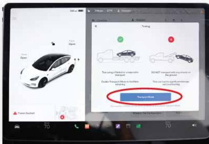
La détection d'une clé et alimentation basse tension sont requises pour activer le mode **TRANSPORT**. Le véhicule doit être sous tension.
