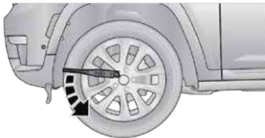
Loosen Lug Nuts
